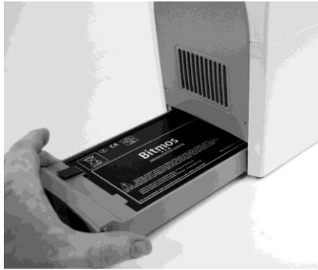
Akkuschublade samt Akku in den aeroplus m einfädeln und hörbar einrasten lassen.
